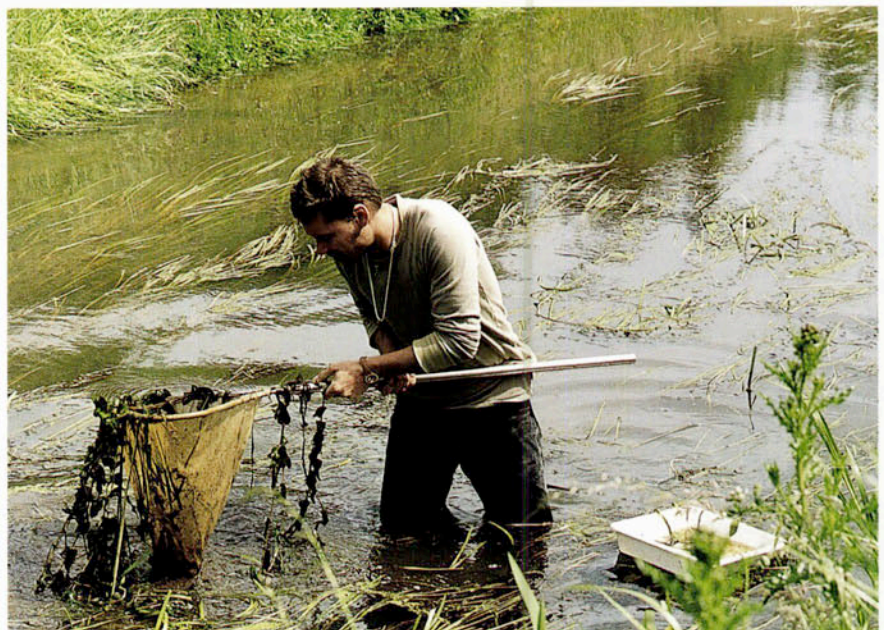
FIGUUR 3 Foto die de wijze van bemonstering laat zien. De inhoud van het schepnet wordt in de witte bak (rechts) overgebracht. In deze witte bak zijn de larven beter te onderscheiden van de modder- en plantenresten (foto: W. Verberk).
